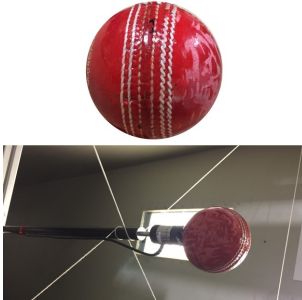
Aérodynamique des balles 1/2 lisse et 1/2 rugueuses
